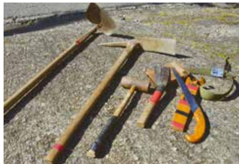
(写真右下) 左から、ジョレン、ツルハシ、ハンマー、ナタ、ノコギリ
